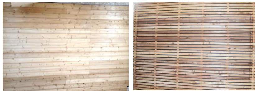
Preizkušeni vzorci: Deske spojene po principu pero-utor (levo) in lesene letve z režami (desno) podjetja RIKO Hiše
