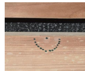
Manjša vdolbina in razbarvanje na mestu udarca jeklene krogle.
