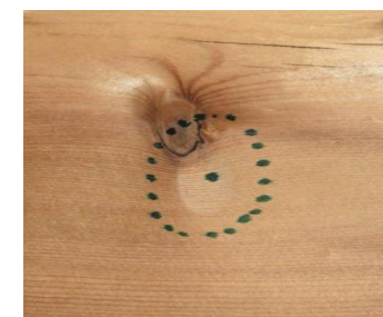
Manjša vdolbina in razbarvanje na mestu udarca jeklene krogle.
