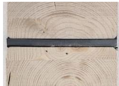
Preizkušeni vzorci: PST_I (levo) in PM_P (desno) tip fleksibilnega konstrukcijskega spoja.
