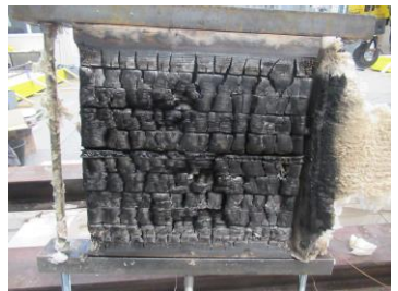
Fleksibilen spoj v nategu po preizkusu požarne odpornosti: neizpostavljena stran (levo), izpostavljena stran (desno).
