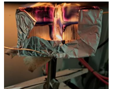
Preskus fleksibilnega spoja s stožčastim kalorimetrom – simulacija zmanjšanja materiala.
