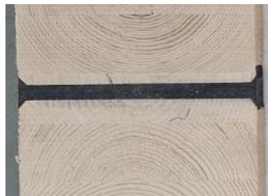
Preizkušeni vzorci: PST_I (levo) in PM_P (desno) tip fleksibilnega konstrukcijskega spoja.
