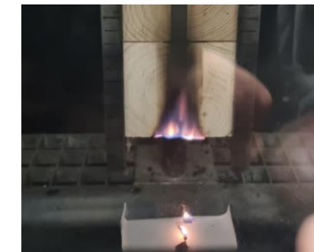
Izpostavljenost malemu plamenu 30 sekund povzroči vžig fleksibilnega spoja in kapljanje gorečega materiala.
