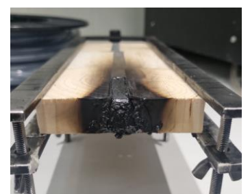
Izpostavljenost malemu plamenu 30 sekund povzroči vžig fleksibilnega spoja in kapljanje gorečega materiala.
