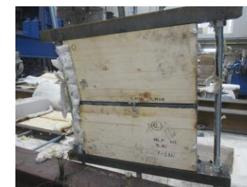
Fleksibilen spoj v nategu po preizkusu požarne odpornosti: neizpostavljena stran (levo), izpostavljena stran (desno).
