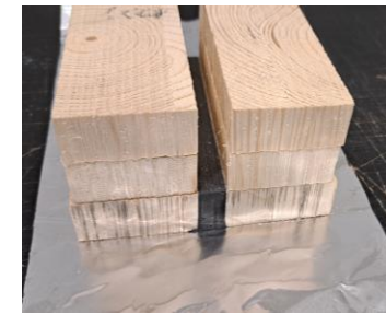
Preskus fleksibilnega spoja s stožčastim kalorimetrom – simulacija zmanjšanja materiala.
