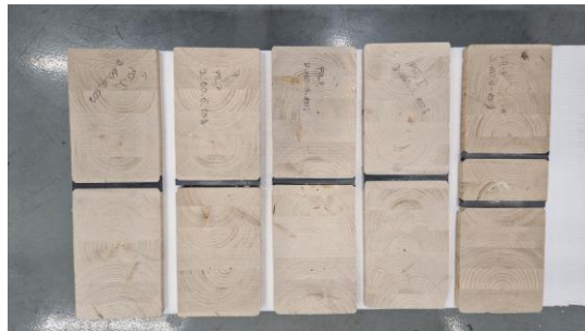
Prečni prerez lesenih elementov s fleksibilnimi konstrukcijskimi spoji.
