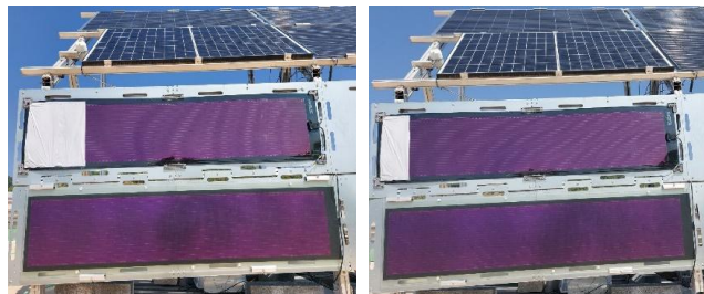
Prueba de sombreado exterior de los módulos Heliatek.
