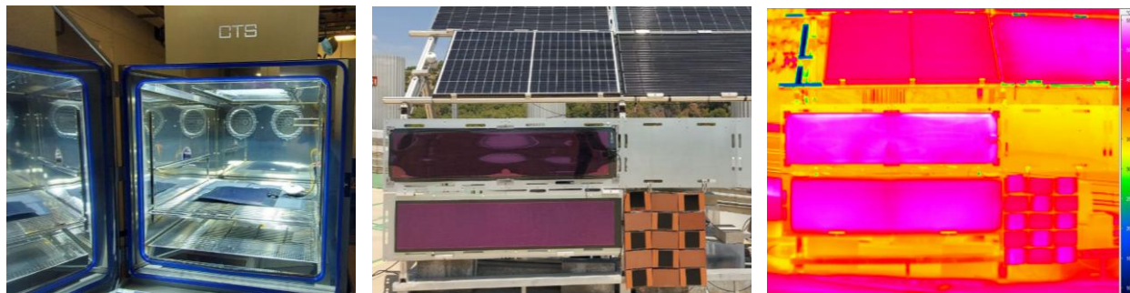
Pruebas en interiores y exteriores de los módulos HeliaFilm, e imagen de su caracterización térmica.
