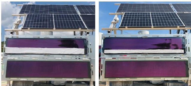
Prueba de sombreado exterior de los módulos Heliatek.
