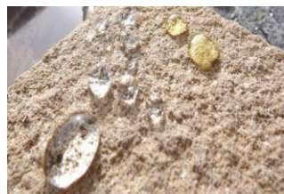
Rivestimento idrofobico di TECNAN applicato a materiali da costruzione porosi
